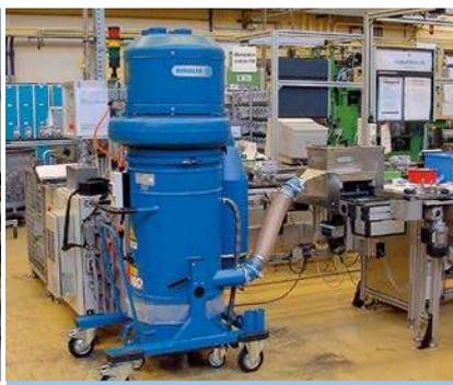
Entstauber in Fertigungslinien integriert
