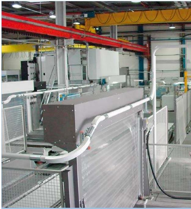
● Saugstelle mit Schwenkarm und Rohrleitung
