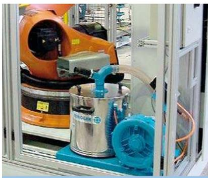
RA 40 integriert in Roboterzelle
