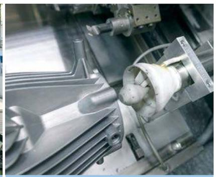
Düse im 3D-Druck für besondere Absaugaufgaben
